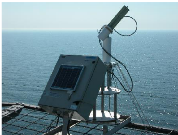
Radiometru oceanic instalat la Platforma "Secția 7"
